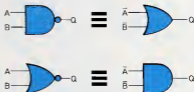
En la figura aparece la representación del Triestado de De Morgan mediante símbolos lógicos para circuitos electrónicos.
